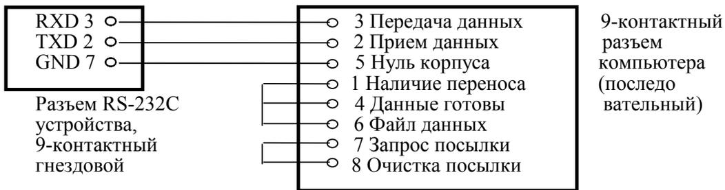
Схема соединения с выносным индикатором:
