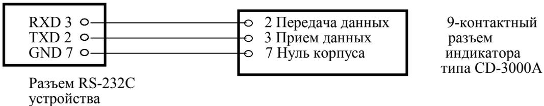
Схема соединения с принтером серии CP-7000:
