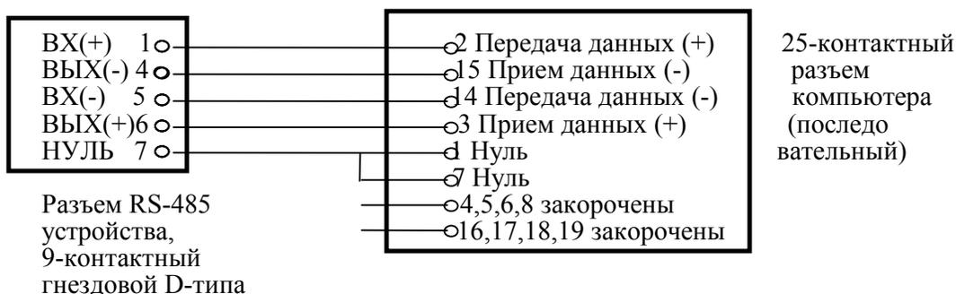
Схема соединения с выносным индикатором:
