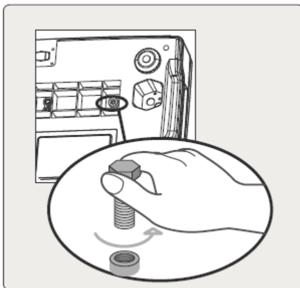
Рис. 4 Розміщення транспортувального болта в нижній частині корпусу ваг
